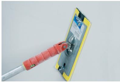
7. Высохшую поверхность шлифуют и после очищают от пыли, например, щеткой, до начала отделочных работ.
