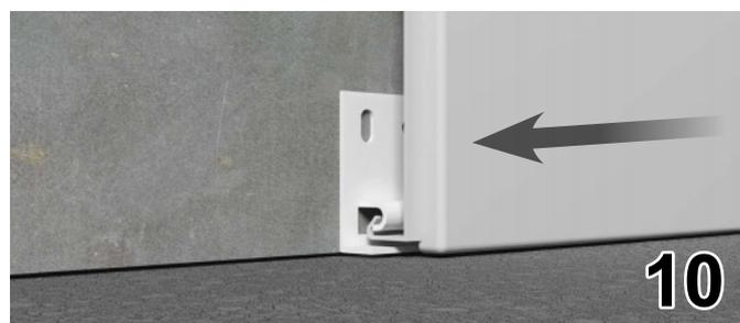
Оставляйте зазор между панелями ЯФАСАД и декоративной системой 8-10 мм для компенсации теплового расширения. (рис. 11)
