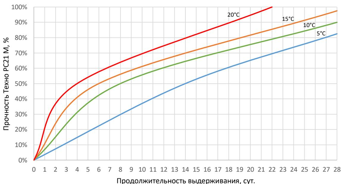
В зимний период необходимо обеспечить температурные условия окружающей среды и основания от +5°C до +30°C для набора 50% от проектной прочности на сжатие (3 МПа). Затем обогрев может быть остановлен. Проектная прочность на сжатие (6 МПа) будет достигнута при сезонном оттаивании материала, при достижении температуры окружающей среды и основания выше +5°C. Для окончательного выравнивания поверхности рекомендуется использовать шпаклевки Основит.
